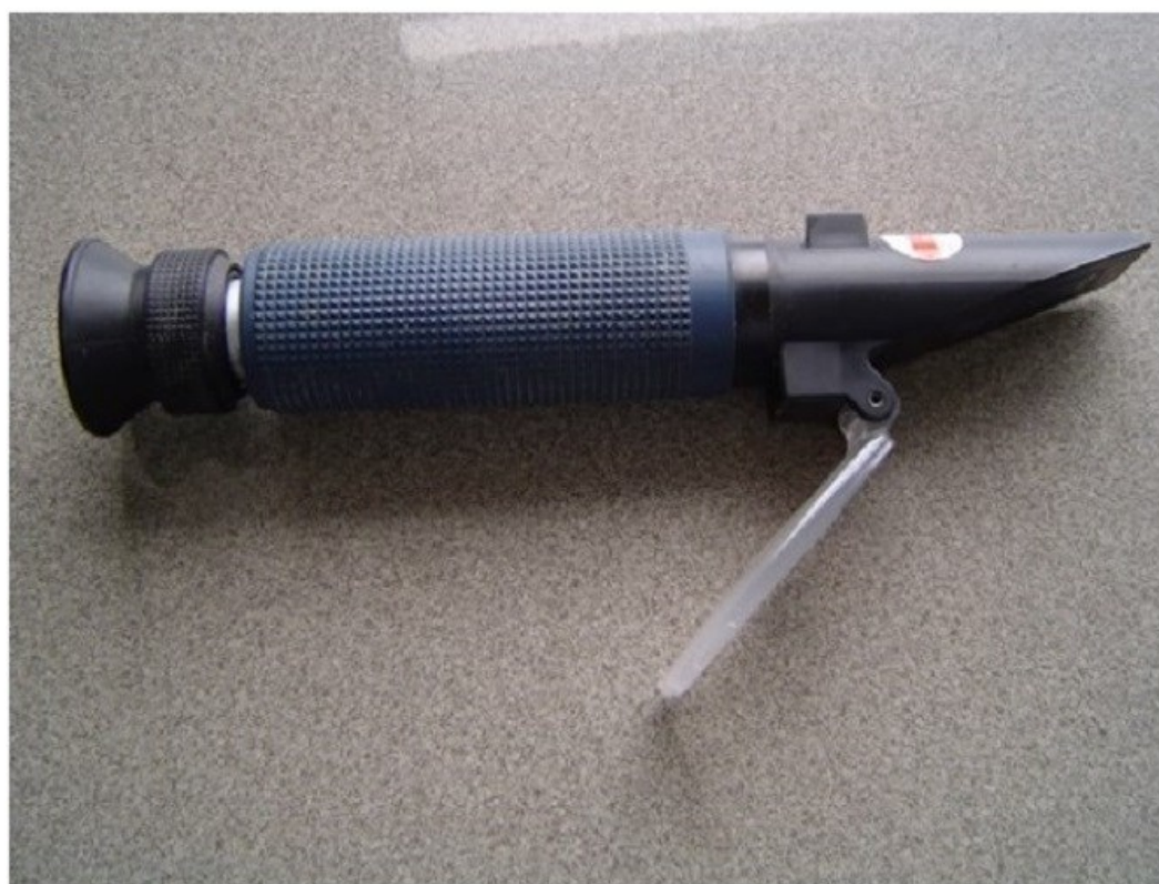
رفاکتمتر جهت اندازه‌گیری میزان TSS یا بریکس در زمان برداشت
